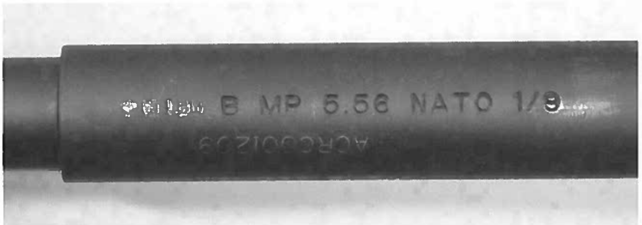
Abbildung 4: Bushmaster BACR – Lauf mit Beschußzeichen, Kennzeichnung, Kaliber und Seriennummer
