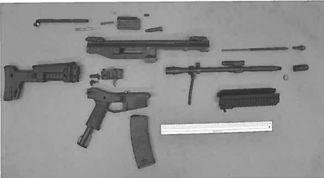
Abbildung 3: Bushmaster BACR – modularer Aufbau
