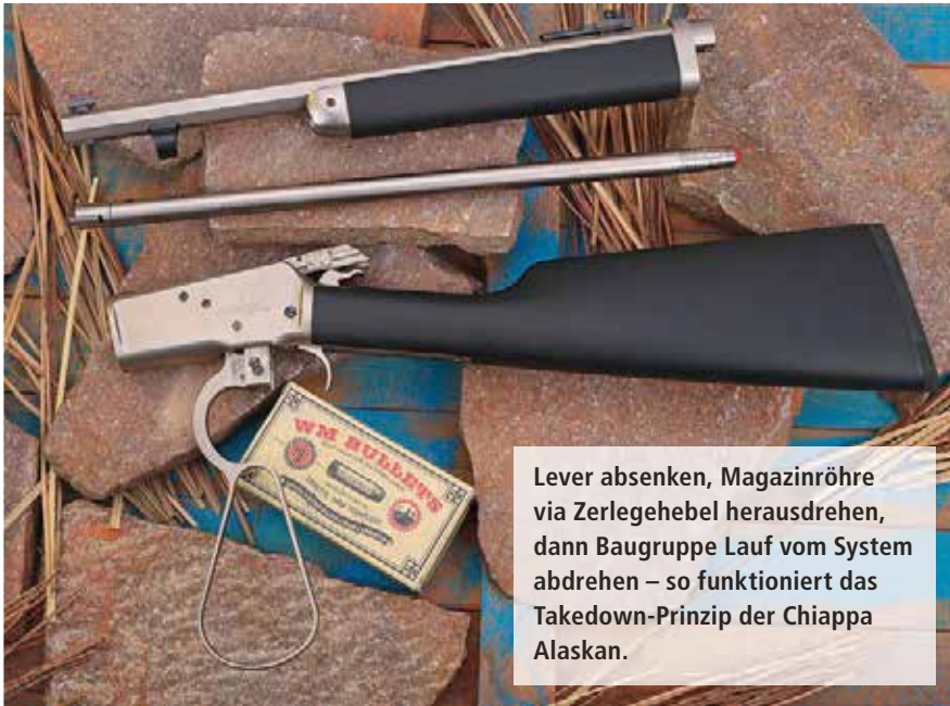
Der Zerlegehebel der Chiappa Alaskan klappte infolge der Schusserschütterung beim Testen regelmäßig auf.
