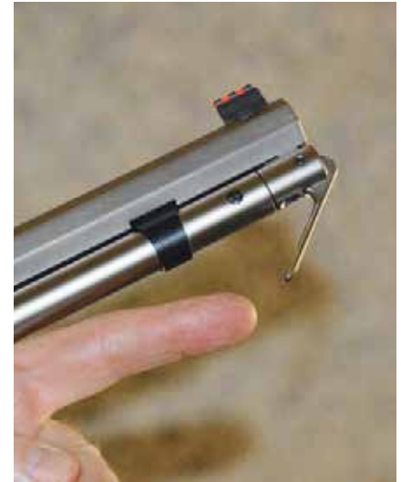
Der Zerlegehebel der Chiappa Alaskan klappte infolge der Schusserschütterung beim Testen regelmäßig auf.
