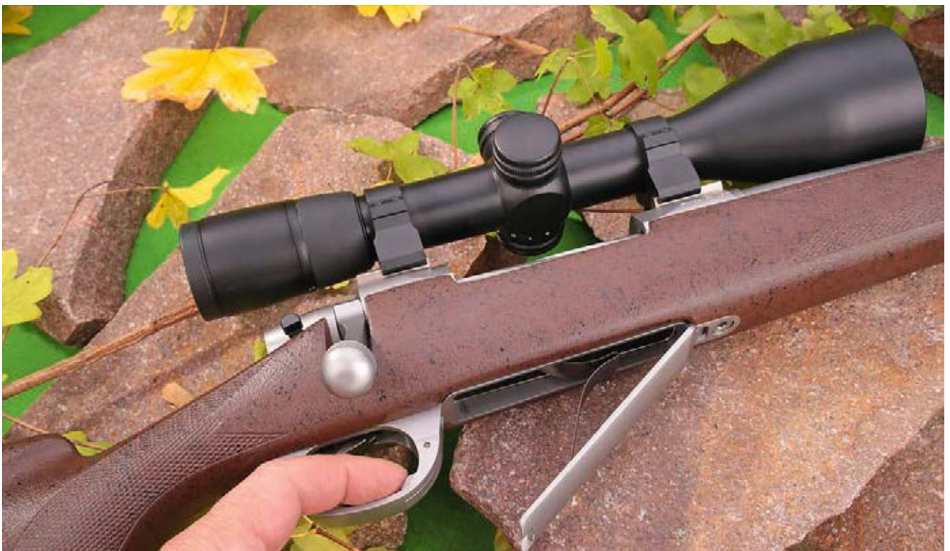
Das Mittelschaftmagazin der Sporter fasst drei Patronen im Kaliber .300 Winchester Magnum. Die Öffnungstaste für den Klappdeckel des Mittelschaftmagazins sitzt gut erreichbar – und gut bedienbar – vorn im Abzugsbügel.
